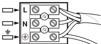
5. Подключите провода питания с помощью монтажных клемм по схеме:
