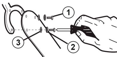
8. Прикрутите лопасти вентилятора к U-образным металлическим держателям лопастей с помощью винтов (1), шайб (2) и бумажных шайб (3) из комплекта поставки, располагая головки винтов на нижней плоскости лопастей.
