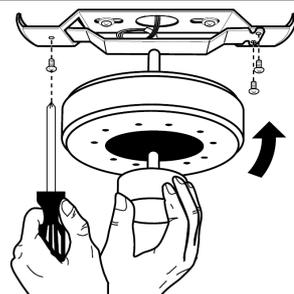
6. Зафиксируйте вентилятор на монтажной пластине с помощью крепежных элементов, входящих в комплект поставки.
