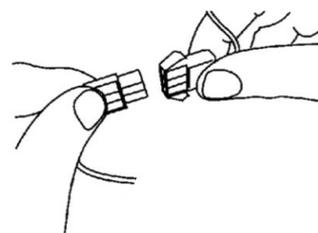
3. Плотно соедините штекера встречных четырехразъемных электрических клемм до щелчка.
