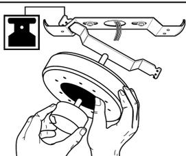
4. Поднимите вентилятор и подвесьте его на монтажной пластине, вставив "Т" - образный конец кронштейна в паз пластины. Таким образом, можно будет осуществить подключение вентилятора, не поддерживая его вручную.
