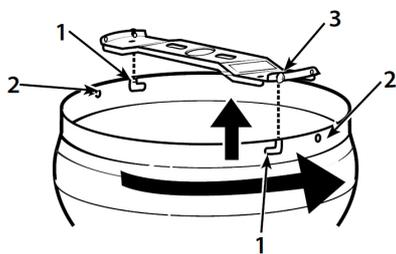
7. Продвиньте вверх припотолочный колпак, закрепите его с помощью винтов и зубчатых шайб (3) сначала через Г-образные пазы (1), затем через пазы (2).
