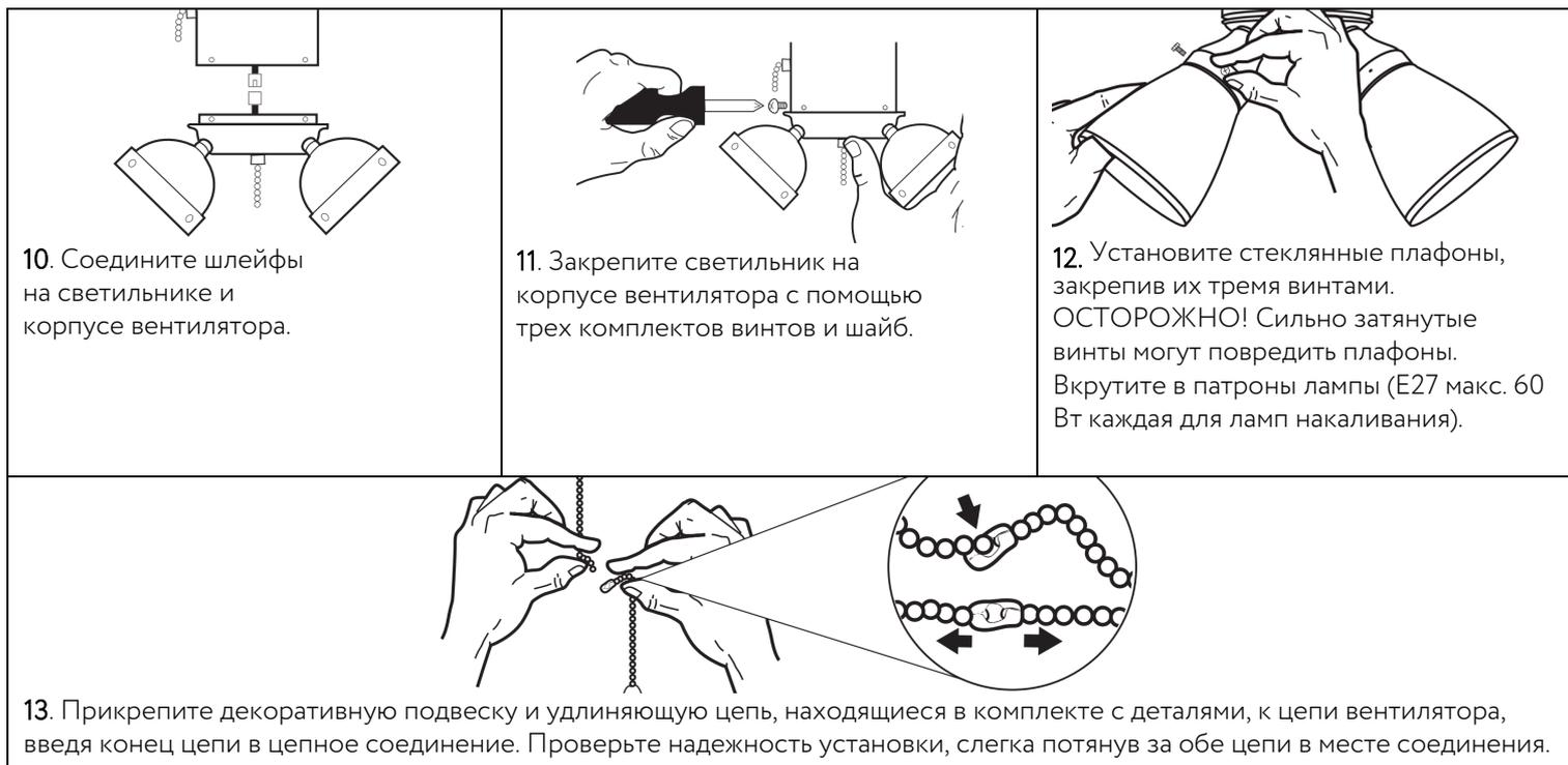
10. Соедините шлейфы на светильнике и корпусе вентилятора.
