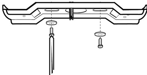
2. Просверлите два монтажных отверстия на потолке и надежно закрепите на нем планку, используя для этого подходящие дюбели, шайбы и саморезы. Пропустите потолочные провода питания сквозь круглое отверстие в планке.
