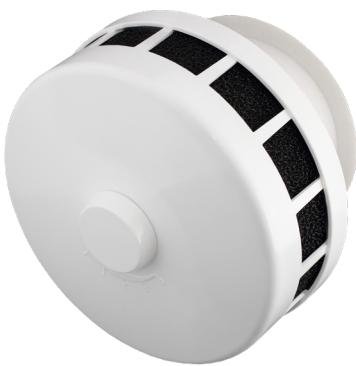
Патрубок клапана с силиконовым уплотнителем продевается через квадратную уплотнительную прокладку, плотно вводится в трубу и фиксируется к стене с помощью 4-х шурупов. Узел регулировки позволяет регулировать степень открытия/закрытия заслонки при помощи утопленного колесика на корпусе или шнура.
