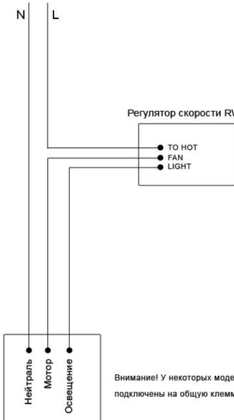
Внимание! У некоторых моделей вентиляторов провода мотора и освещения подключены на общую клемму. При данной схеме подключения их необходимо разделить!
