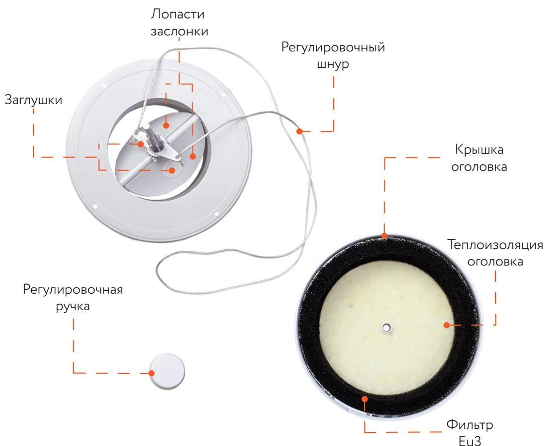
Патрубок (фланец) клапана с силиконовым уплотнителем плотно вводится в трубу и фиксируется к стене с помощью 4-х шурупов. Узел регулировки позволяет регулировать степень открытия/закрытия заслонки при помощи утопленного колесика на корпусе или шнура. Фильтр класса EU3 (G3) изготовлен из пористого моющего синтетического материала, эффективно задерживающего пыль и шум. На фасадную сторону крышки оголовка клапана нанесена фактурная шкала, показывающая степень открытия заслонки
