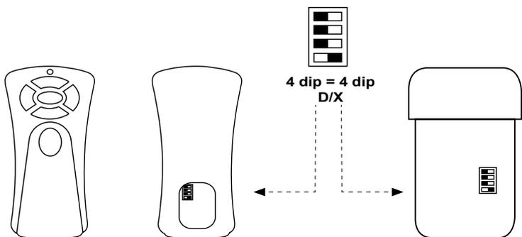
D=dimmer X=ON/OFF: solo nel trasmettitore
