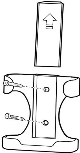
В случае необходимости установить держатель передатчика на стену, используя предназначенные для этого винты.
