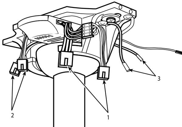
Подвесив вентилятор на консоль, вставить 4-полюсный соединитель кронштейна в розетку 4-полюсного соединителя дистанционного приемного устройства (1). Вставить 4-полюсный соединитель дистанционного приемного устройства в 4-полюсный соединитель вентилятора (2). Прикрепить заземляющий провод (3) стержня к кронштейну.
