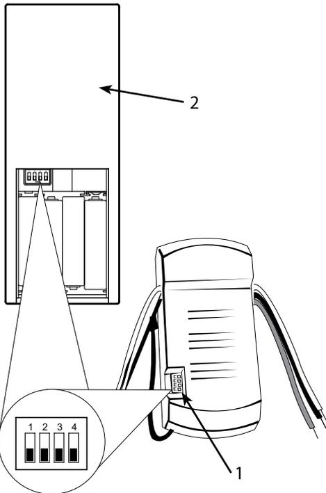
Данный блок дистанционного управления имеет 16 кодовых комбинаций для предотвращения возможных помех, которые идут от него или от других блоков дистанционного управления. Переключатели частоты на приемнике (1) и передатчике (2) имеют заводскую настройку. Убедитесь, что переключатели на передатчике (2) и приемнике (1) находятся в одинаковом положении; вентилятор будет работать при любой комбинации настроек, если установки на передатчике и приемнике одинаковы.
