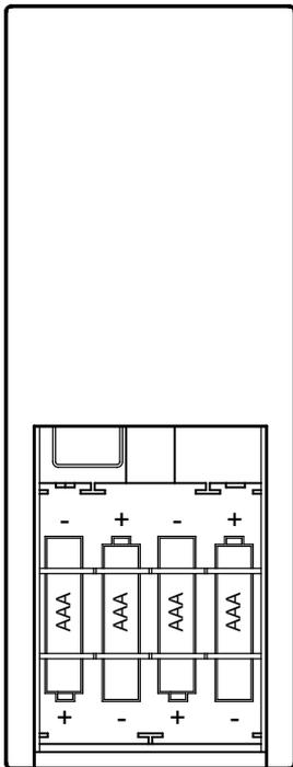
Примечание: Чтобы вставить 4 батарейки AAA, необходимо снять крышку батарейного отсека на обратной стороне передатчика, вставить батарейки и закрыть крышку. Батарейки в комплект не входят.
