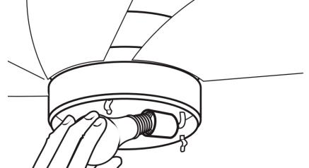
11. Установите лампу (тип E14 и макс. мощность не более 60 Вт для ламп накаливания).
