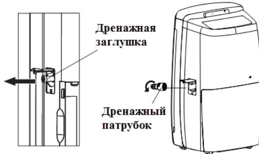
4. Вставьте дренажный шланг в патрубок. Высота дренажного шланга по вертикали должна быть ниже водовыпускного отверстия. Следите за тем, чтобы посторонние предметы не блокировали водовыпускное отверстие, чтобы оттоку воды ничто не мешало. Периодически проверяйте состояние дренажного патрубка и шланга, чтобы убедиться в том, что они подсоединенны достаточно плотно, а также убедиться в отсутствии повреждений или блокировки.
