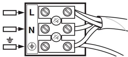
4. Подключите провода питания с помощью монтажных клемм по схеме:
