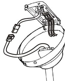
3. Для удобства подсоединения проводов питания, временно подвесьте вентилятор на крюк-кронштейн, расположенный на монтажной пластине.
