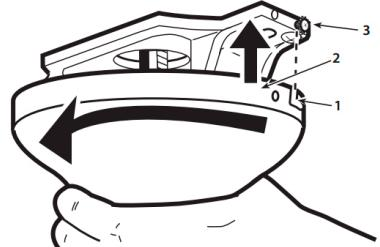
6. Продвиньте вверх колпак с вентилятором и закрепите его с помощью винтов и зубчатых шайб (3) сначала через Г-образные пазы (1), затем через пазы (2).
