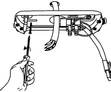
2. Просверлите два монтажных отверстия в потолке и надежно прикрепите монтажную пластину к потолку. Пропустите провода питания сквозь круглое отверстие в монтажной пластине.
