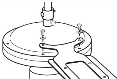
7. Закрепите лопасти вентилятора на корпусе с помощью винтов и шайб (в комплекте).
