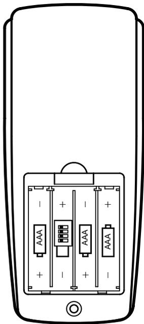
Примечание: Чтобы вставить 4 батарейки AAA, необходимо снять крышку батарейного отсека на обратной стороне передатчика, вставить батарейки и закрыть крышку. Батарейки в комплект не входят.
