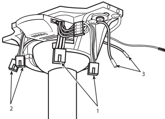
Подвесив вентилятор на консоль, вставить 4-полюсный соединитель кронштейна в розетку 4-полюсного соединителя дистанционного приемного устройства (1). Вставить 4-полюсный соединитель дистанционного приемного устройства в 4-полюсный соединитель вентилятора (2). Прикрепить заземляющий провод (3) стержня к кронштейну.
