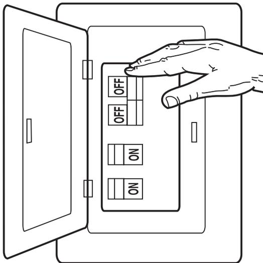
Во избежание удара током, следует отключить блок предохранителей.
