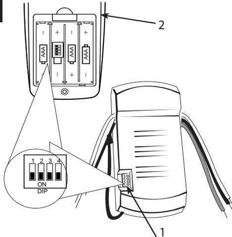
Данный блок дистанционного управления имеет 16 кодовых комбинаций для предотвращения возможных помех, которые идут от него или от других блоков дистанционного управления. Переключатели частоты на приемнике (1) и передатчике (2) имеют заводскую настройку. Убедитесь, что переключатели на передатчике (2) и приемнике (1) находятся в одинаковом положении; вентилятор будет работать при любой комбинации настроек, если установки на передатчике и приемнике одинаковы.
