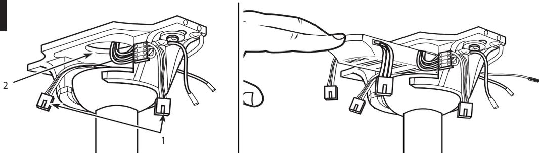
Подвесив вентилятор на кронштейн, следует убедиться в том, что штепсели вентилятора и распределительной коробки (1) убраны из пространства, расположенного над шариком стержня (2). Поместить дистанционное приемное устройство в пространство над шариком стержня, как показано на рисунке.
